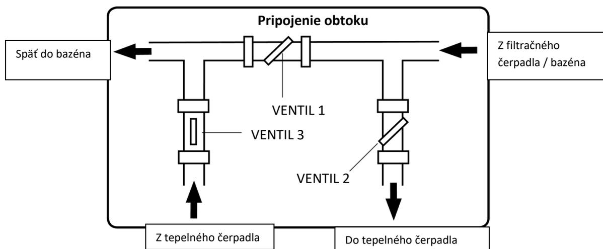
Tepelné čerpadlo je vybavené 2 závitmi, ktoré umožňujú pripojenie vstupnej a výstupnej armatúry (d50). Pre prepájanie s filtračným obehom používajte PVC trubku d50 alebo 50/38mm adaptéry (6/4"). Prosíme, prečítajte si časť 3.3.4 *Popis základných častí* aby ste sa uistili, ktorý závit je prítok vody a ktorý je odtok vody. Na závit je vhodné použiť lubrikačný olej na utesnenie pripojenia.
