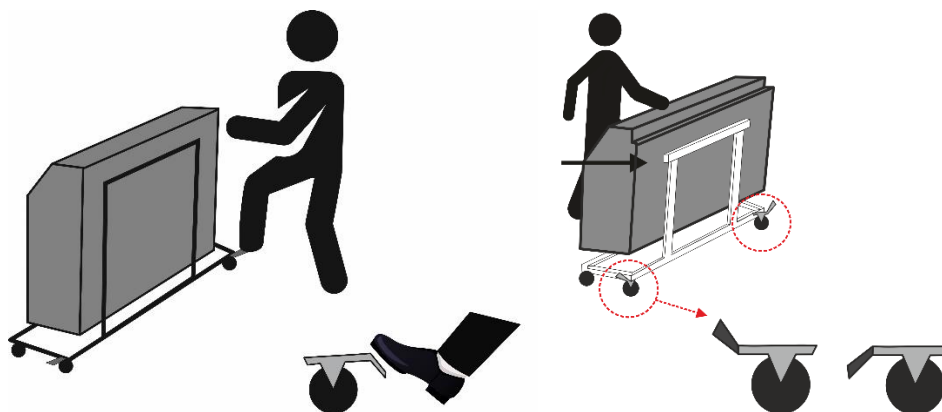
Obr.1 Po přesunutí odvlhčovače na mobilním stojanu na místo instalace, zajistěte brzdu kol. Brzda kol je zajištěna, když je páčka brzdy dolů. Brzda kol je odjištěna, když páčka je nahore.
