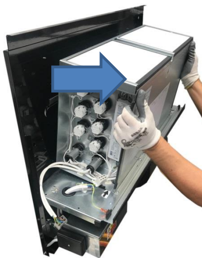
3. sejmi horní plech lemující HEPA FILTRY.
