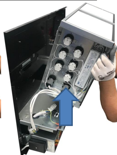
3. sejmi horní plech lemující HEPA FILTRY.
